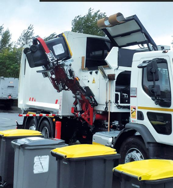
Attention, innovation ! Grand Châtelleraut modernise la collecte des déchets avec l'acquisition de **nouveaux camions équipés d'un bras robotisé**. Ce système permet de vider les bacs de manière quasi autonome. Grâce à cette technologie, la collecte nécessite désormais **un seul opérateur**, réduit significativement les risques de troubles musculo-squelettiques et d'accidents de travail liés à la manipulation des conteneurs et valorisant aussi l'expertise des agents de collecte des déchets.
